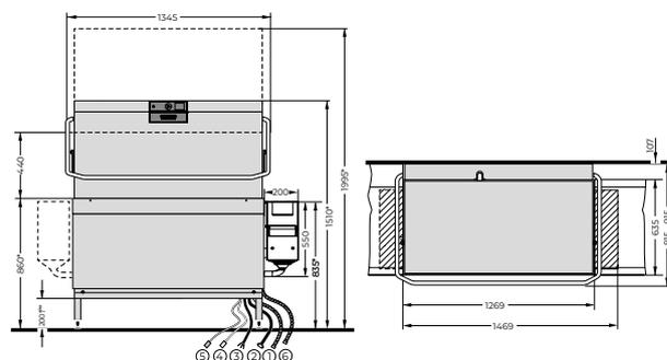
AMXXL et AUPL: hauteur du profil de la table de 40 mm max. pour une installation en angle.
